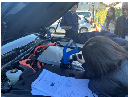
3 次バックアップシステム（FCEV から建物への給電）
